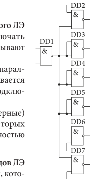
Рис. 41. Схема соединений ЛЭ с разветвлением по выходу
