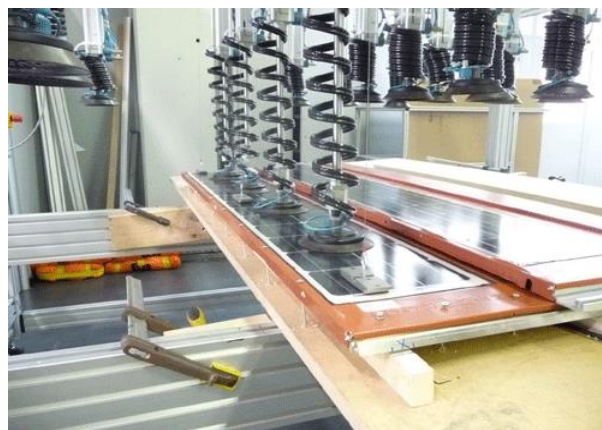
Рисунок 4.6 – Пример испытания на прочность для модулей «солнечной черепицы»
