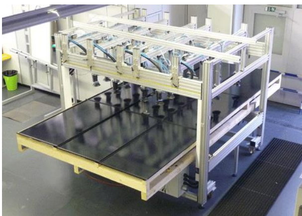
Рисунок 4.6 – Пример испытания на прочность для модулей «солнечной черепицы»
