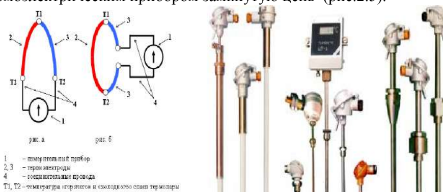
Рис.2.5 Включение вторичного прибора в измерительную цепь с термопарой
