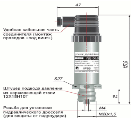
Рис.3.9. Конструктивное исполнение и размеры датчика давления ПД
