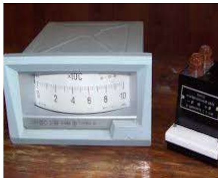
Рис.2.10 Принципиальная схема и внешний вид магнитоэлектрического логометра
