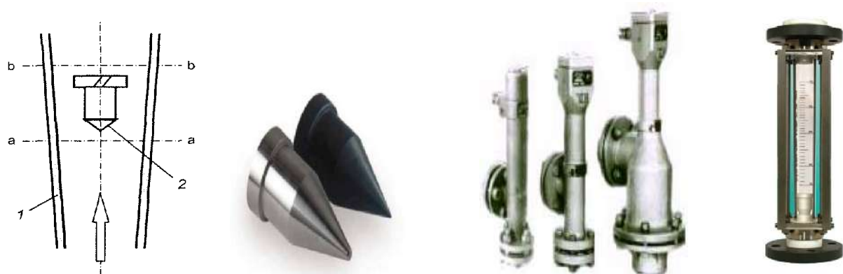
Рис.4.2 Схема ротаметра, поплавки и внешний вид ротаметров
