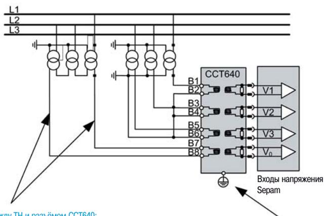
Прокладка электропроводки между ТН и разъёмом ССТ640:
