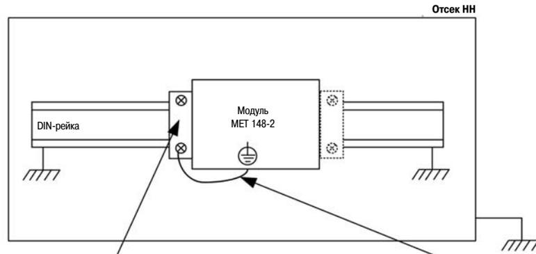
Клемма заземления (соединённая с DIN-рейкой) размещается рядом с модулем
