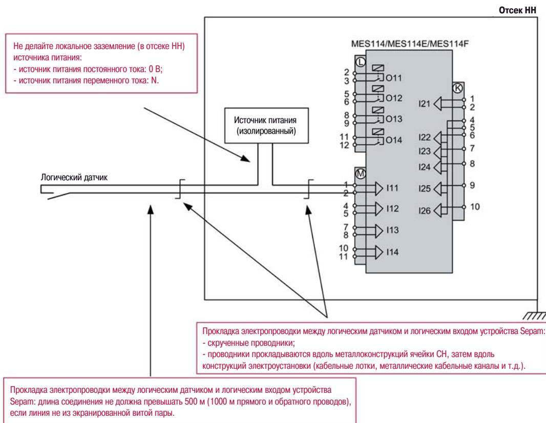
Отсутствие заземления источника питания (0 В или N) обеспечивает доступность информации, даже в случае повреждения изоляции одного из электрических проводников, присоединённых к логическому датчику.
