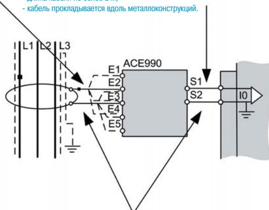
Входные и выходные соединения адаптера ACE990 разделены с целью предотвращения взаимовлияния электромагнитных помех между двумя соединениями.
