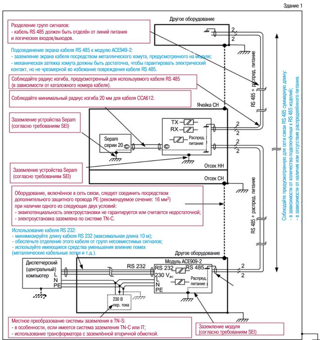
**Примечание:** Если в электроустановке используется система заземления TN-C, токи частотой 50 Гц и токи гармоник нечётных порядков (3-й, 5-й и т.д.) постоянно циркулируют:
