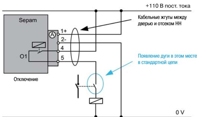
В данном общем случае, дуга, вызванная размыканием цепи отключающей катушки, возникает на клеммах этого контакта, который размыкается до выхода O1.
