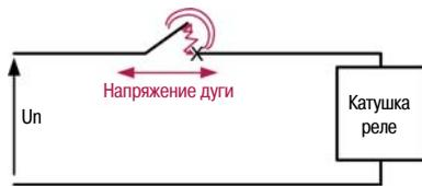
Блок управления автоматическим выключателем обычно содержит контакт положения, соединённый последовательно с катушкой.
