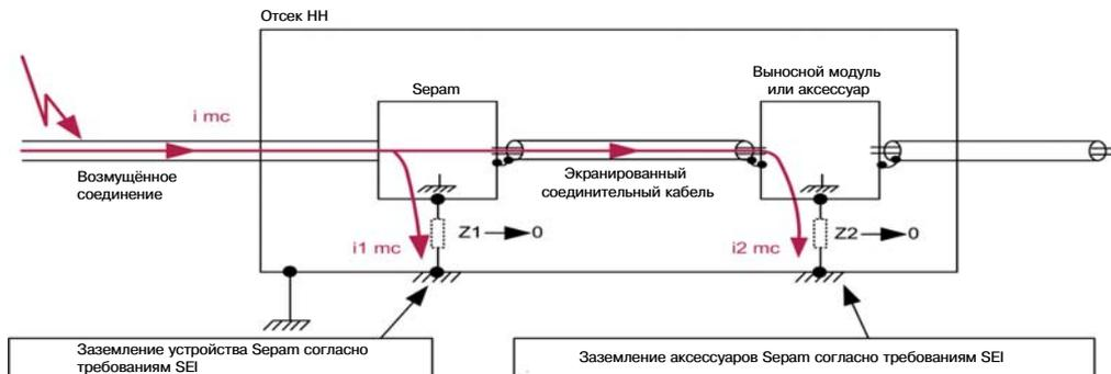
Значение полного сопротивления  $Z1$  и  $Z2$  очень мало:  $i_{mc} = i1_{mc} + i2_{mc}$ , где  $i1_{mc} \gg i2_{mc}$
