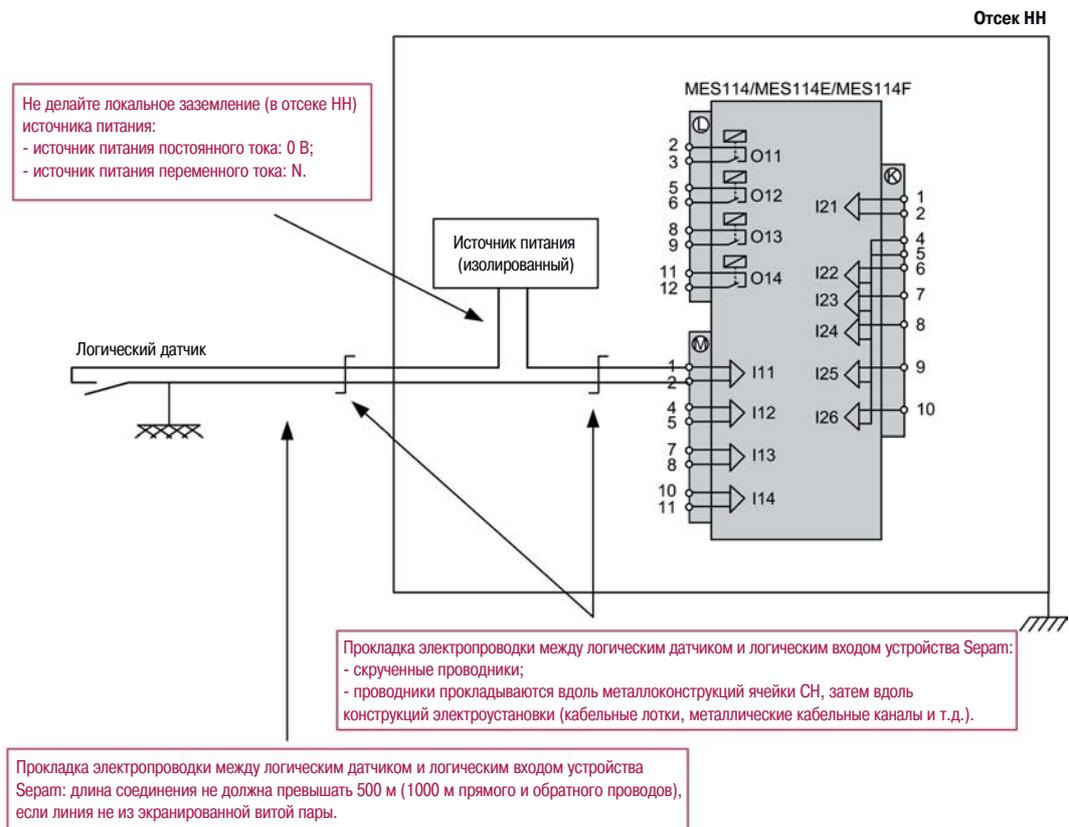
Отсутствие заземления источника питания (0 В или N) позволяет избежать циркуляции токов помех в электрических проводниках логического входа. Такие токи могут нарушить функционирование логического входа.
