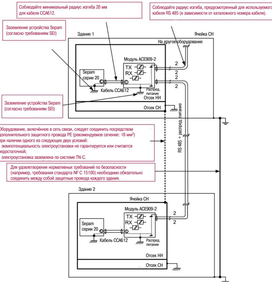
**Примечание:** Настоятельно рекомендуется использовать оптоволоконную сеть связи, если электроустановки имеют большую протяжённость, если их эквипотенциальность не обеспечена или если в них используются системы заземления IT или TN-C.
