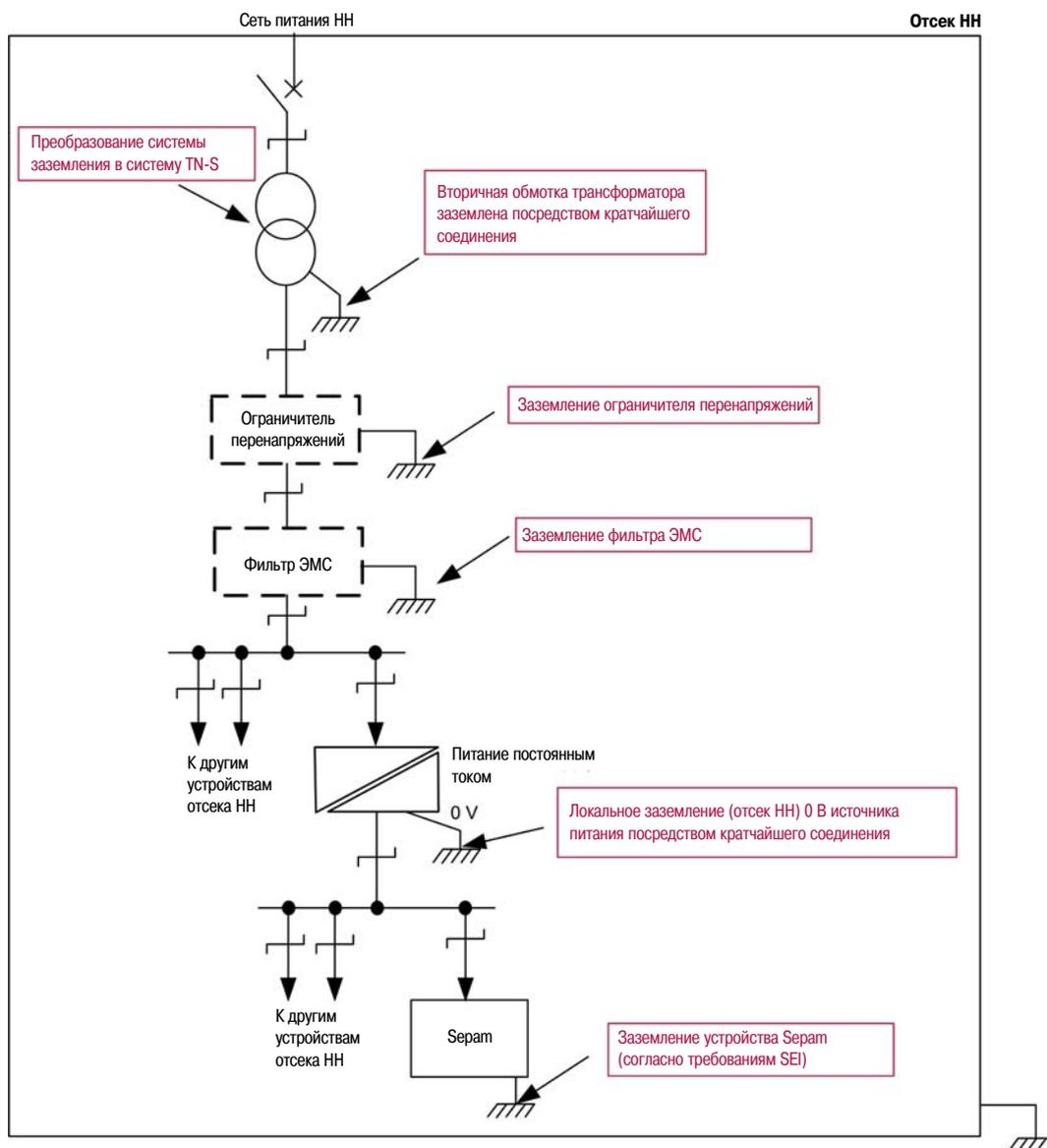
**Питание отсека НН и устройства Sepam неизолированным напряжением постоянного тока**
