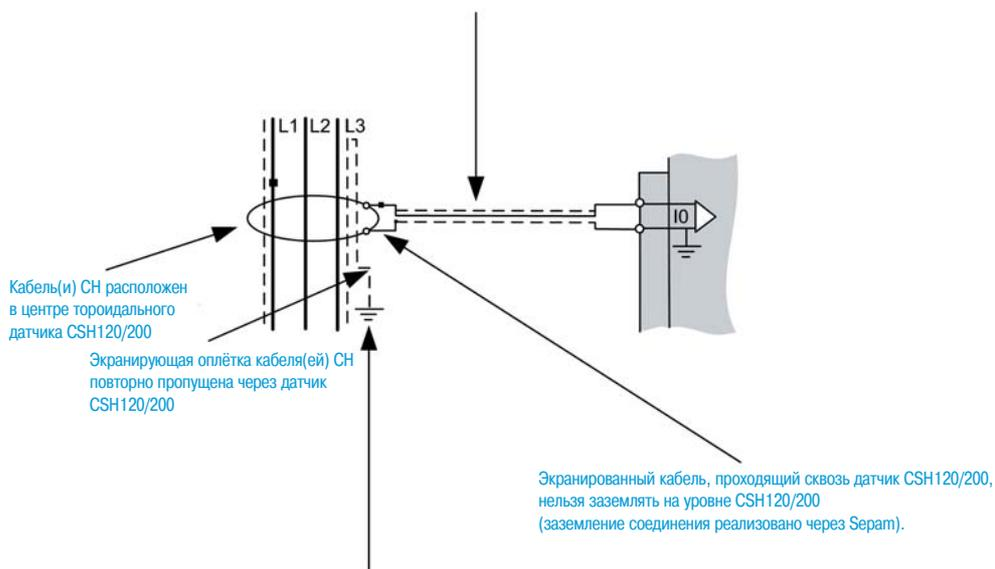
Точка заземления экранирующей(их) оплётки(ток) должна быть соединена с главной шиной заземления ячейки СН. Другими словами, необходимо убедиться, что эта земля объединена с главной шиной заземления ячейки СН.
