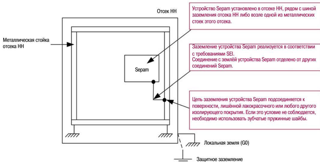
Провод или оплётка заземления, соединяющая Seram и низковольтный отсек, подсоединяется по возможности к поверхности, лишённой лакокрасочного или любого другого изолирующего покрытия. Если это условие не соблюдается, необходимо обязательно использовать зубчатые пружинные шайбы, прокалывающие слой краски отсека НН и обеспечивающие надёжный электрический контакт между проводником заземления и поверхностью отсека.
