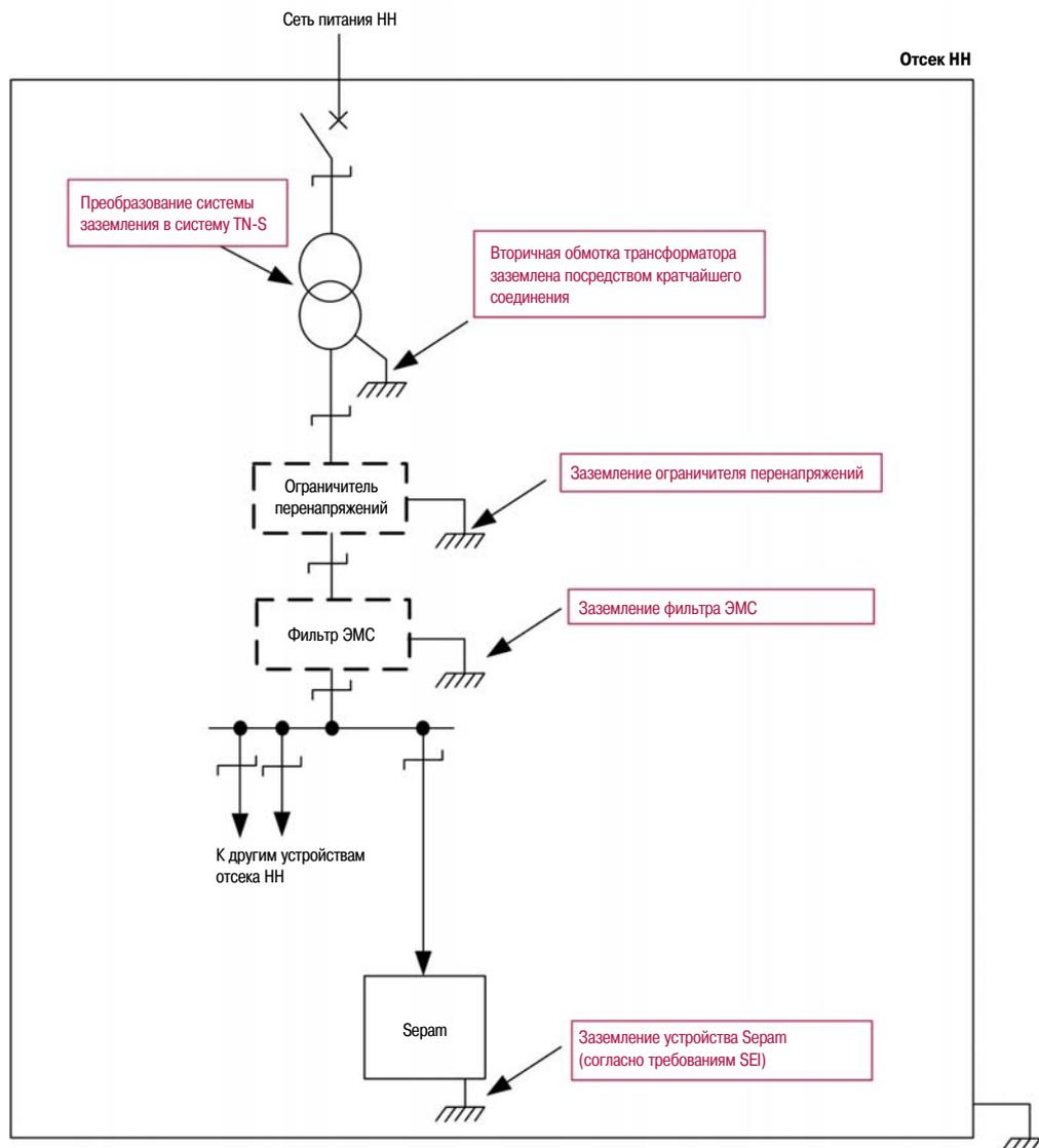
**Питание отсека НН напряжением переменного тока и устройства Seram напряжением постоянного тока**
