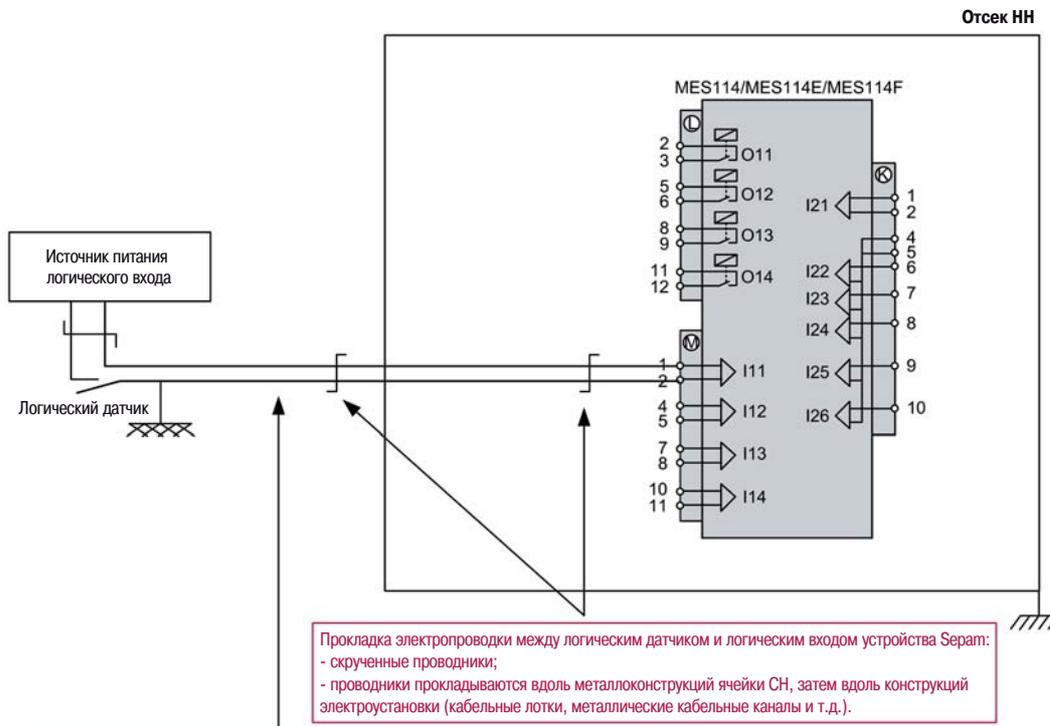
Прокладка электропроводки между логическим датчиком и логическим входом устройства Sepam: длина соединения не должна превышать 500 м (1000 м прямого и обратного проводов), если линия не из экранированной витой пары.
