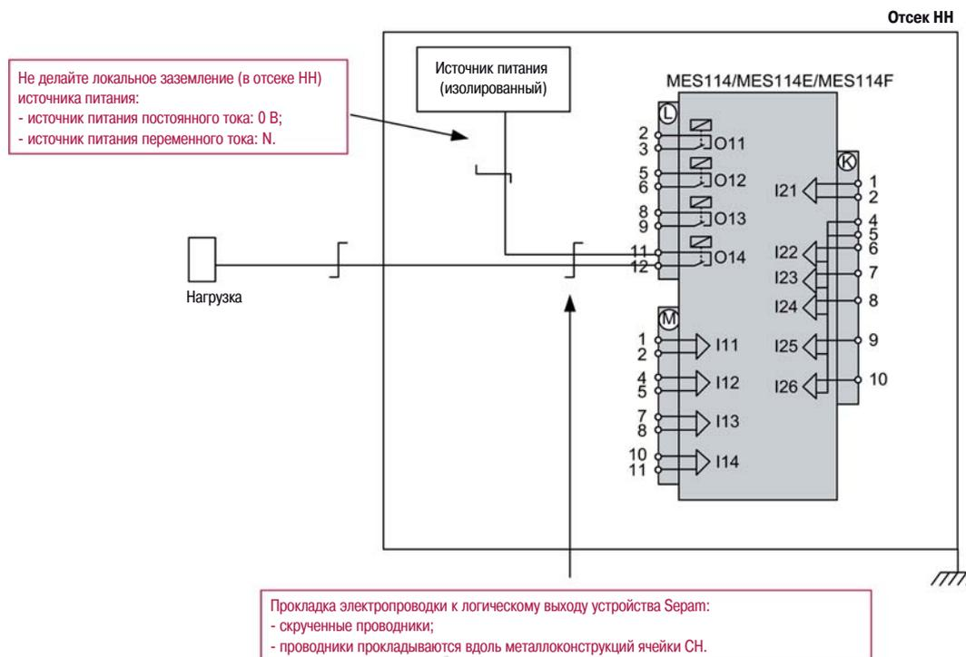
Отсутствие заземления источника питания (0 В или N) обеспечивает готовность функции, даже в случае повреждения изоляции одного из электрических проводников, присоединённых к нагрузке.
