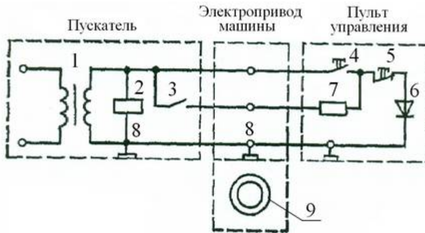
Рис. 13. Принципиальная схема автоматического контроля заземления передвижной машины при вынесенном пульте управления:
