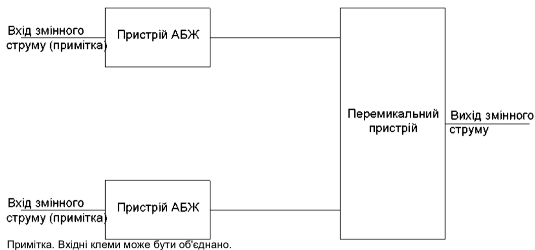
Рисунок А.6 - АБЖ із виділеним резервом без обвідного кола
