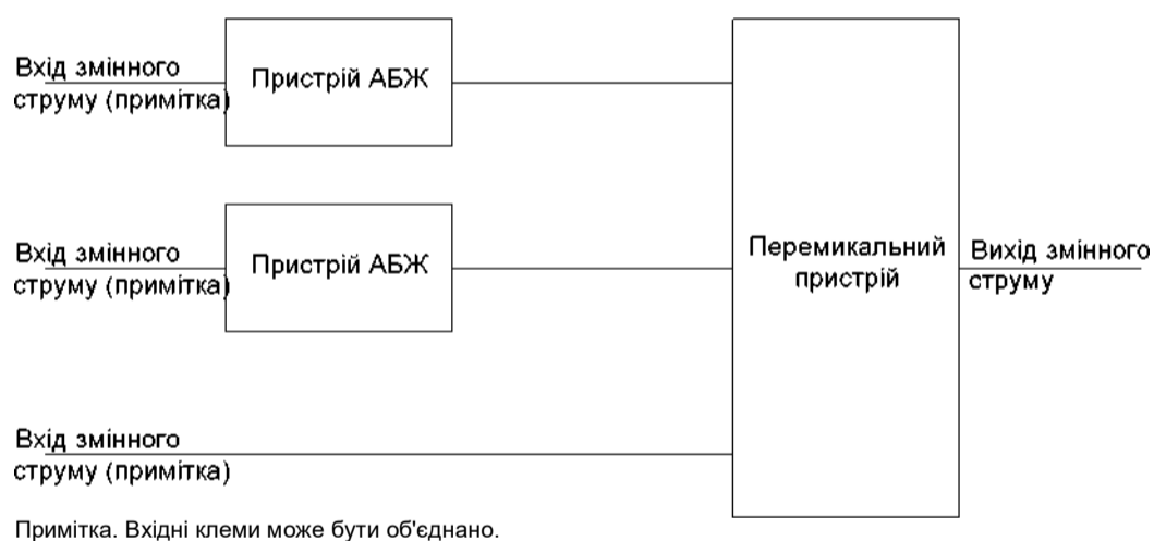
Рисунок А.7 - АБЖ із виділеним резервом з обвідним колом
