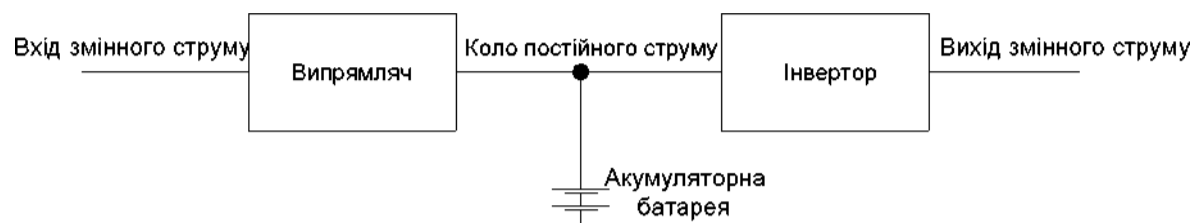
Рисунок А.1 - Одиничний АБЖ із загальним для інвертора та акумуляторної батареї випрямлячем
