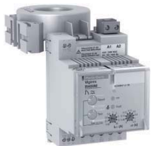
Рис. 11: через посредство тора ток замыкания передает энергию сигнала электромагниту, якорь которого удерживается в притянутом состоянии с помощью постоянного магнита. Когда порог срабатывания достигнут, электромагнит нейтрализует силу притяжения постоянного магнита, якорь под действием пружины отходит от сердечника, приводит в движение контакты – выключатель отключается.
