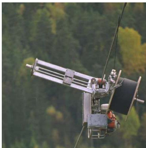
Рисунок 7.4.2 Навивная машинка шпиндельного типа
