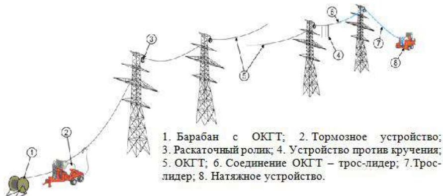
Рисунок 7.4.1 Типовая схема монтажа ОК на ВЛ
