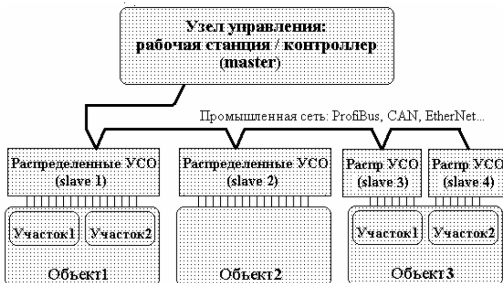
Р и с. 2.2. Централизованная система автоматизации с применением промышленной сети и распределенных УСО
