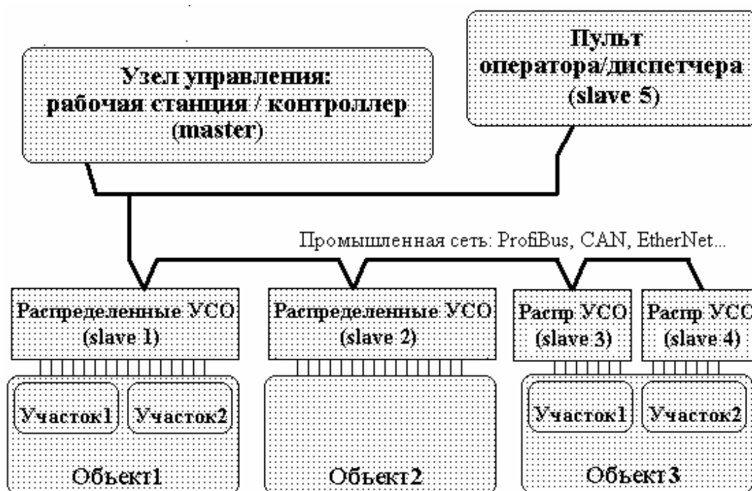
Р и с. 2.3. Распределенная система АСУ на базе промышленной сети с выделенным управляющим контроллером и распределенными УСО
