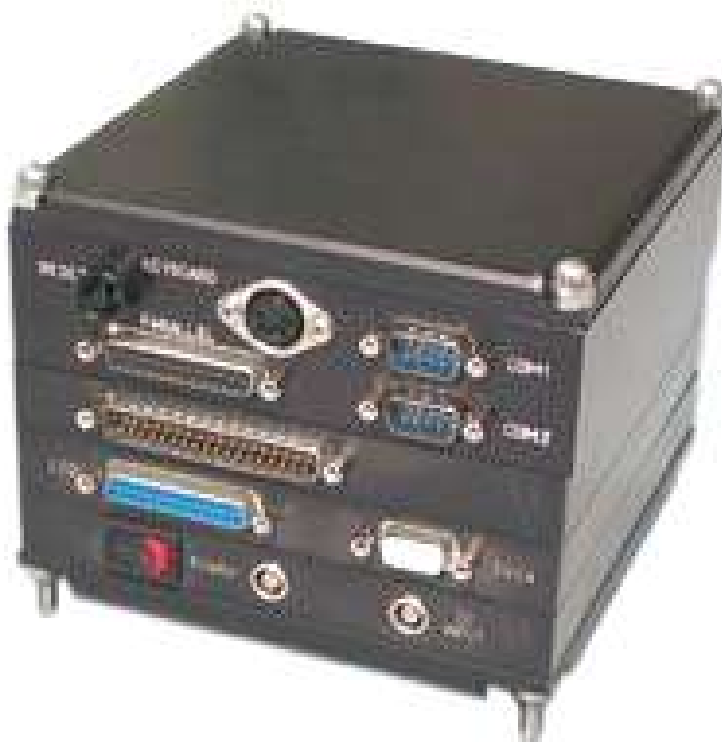
Р и с. 1.10. Промышленный компьютер на платах форм-фактора PC/104.
