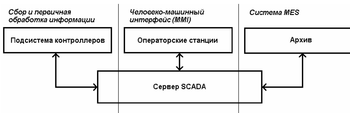
Р и с. 3.4. Области АСУ, охватываемые SCADA-системами.
