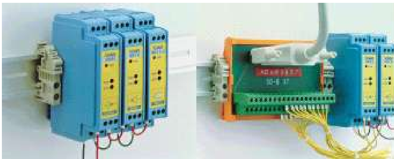
Р и с. 2.23. Внешний вид и подключение модулей ADAM-3000
