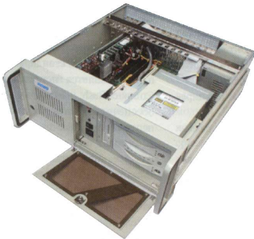
Р и с. 1.1. Промышленный компьютер фирмы ICOS из серии ROBO для встраивания в шкаф
