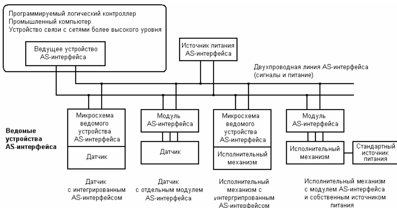
Р и с. 2.7. Состав узлов AS-интерфейса и их развертывание в сеть
