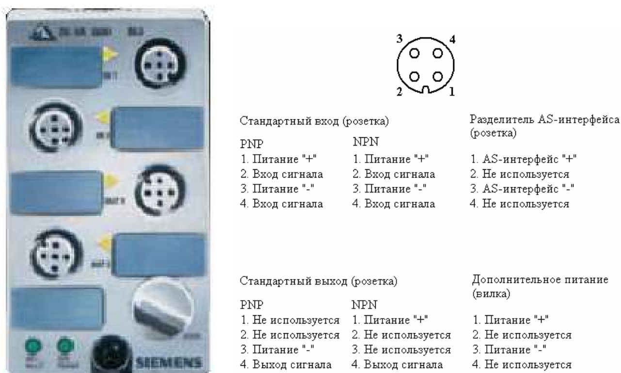
Р и с. 2.12 Оконечное устройство для подключения датчиков фирмы Siemens с разъемами M12 и назначение контактов разъемов.
