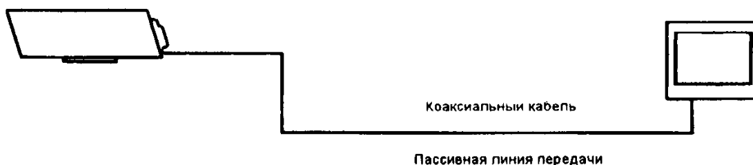
Рис. 10.1 Прямая, пассивная передача видео.
