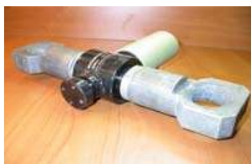
Рис. 5.86. Датчик момента на ключе
