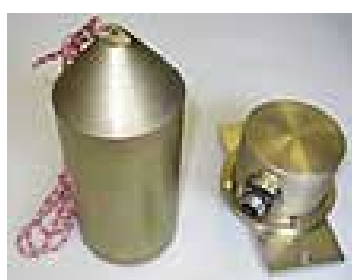
Рис. 5.63. Датчик плотности ПЖ в приемной емкости
