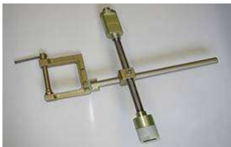
Рис. 5.51. Датчик ходов насоса
