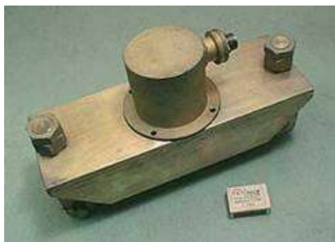
Рис. 5.43. Датчик нагрузки на крюке (1-я модификация)
