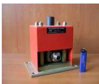
Рис. 5.84. Датчик момента на роторе (первая модификация)
