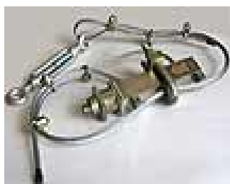
Рис. 5.60. Датчик крутящего момента на роторе
