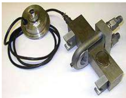
Рис. 5.44. Датчик нагрузки на крюке (2-я модификация)
