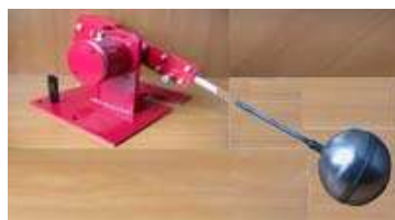
Рис. 5.90. Датчик уровня бурового раствора в емкостях (первая модификация)
