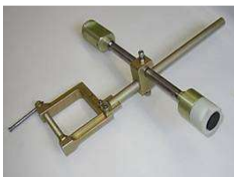
Рис. 5.45. Датчик оборотов ротора
