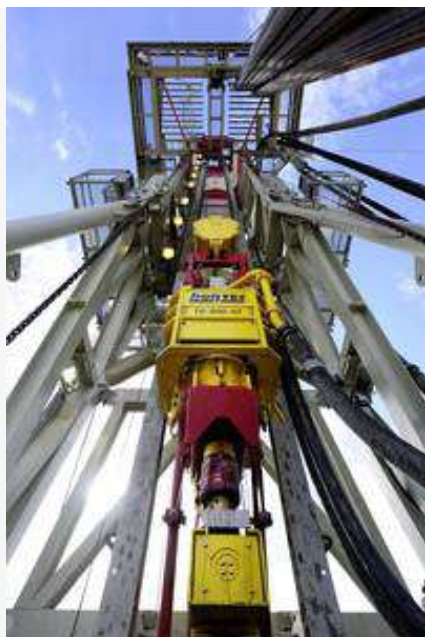
Рис. 4.29. Верхний привод Bentec TD-500-HT
