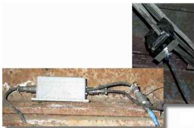
Рис. 5.79. Датчик момента на роторе с электрическим приводом
