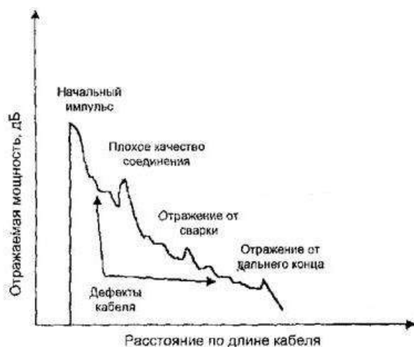
Рисунок 15.1 - Пример рефлектограммы, снятой оптическим рефлектометром.
