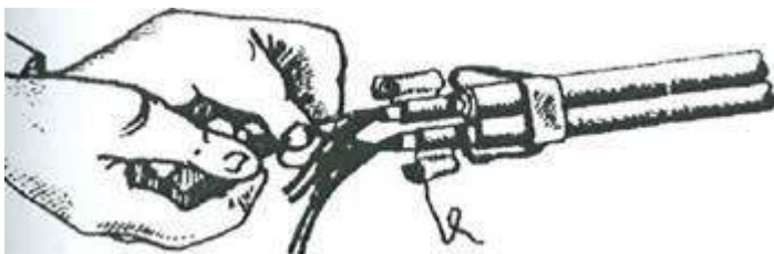
Рисунок 11.47 - Скрутка жил кабеля КСПП (КСППБ).
