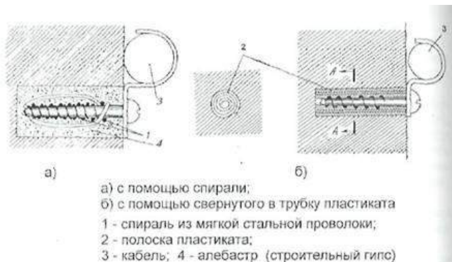
Рисунок 7.19 – Способы крепления фасонной скобы
