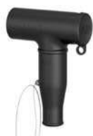
IH-A 24630, IH-A 42630 Изоляционный колпак из гибкой резины с внешним проводящим слоем и предустановленным изолирующим стержнем. Устанавливается в HDC-630 вместо кабельного разъема для того, чтобы временно изолировать вводы распределительного устройства или трансформатора на 630 А.
