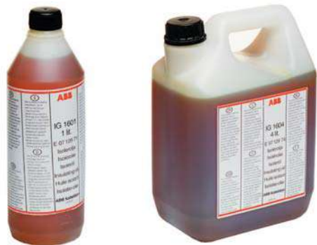
IG 1601, IG 1604 Изоляционное масло для соединительных и концевых муфт для кабелей с бумажной изоляцией на 10-36 кВ. Не требует нагрева выше 10 °С.
