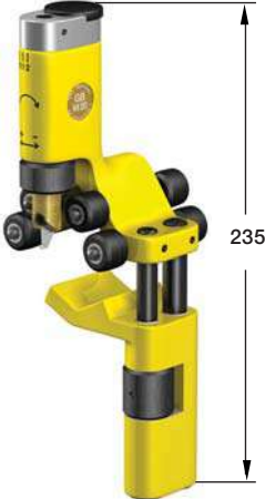
GB-M20 Режущий инструмент для кабельной оболочки и изоляции из сшитого полиэтилена. Диаметр: Ø 15-50 мм. Глубина резания: ≤ 8 мм.
