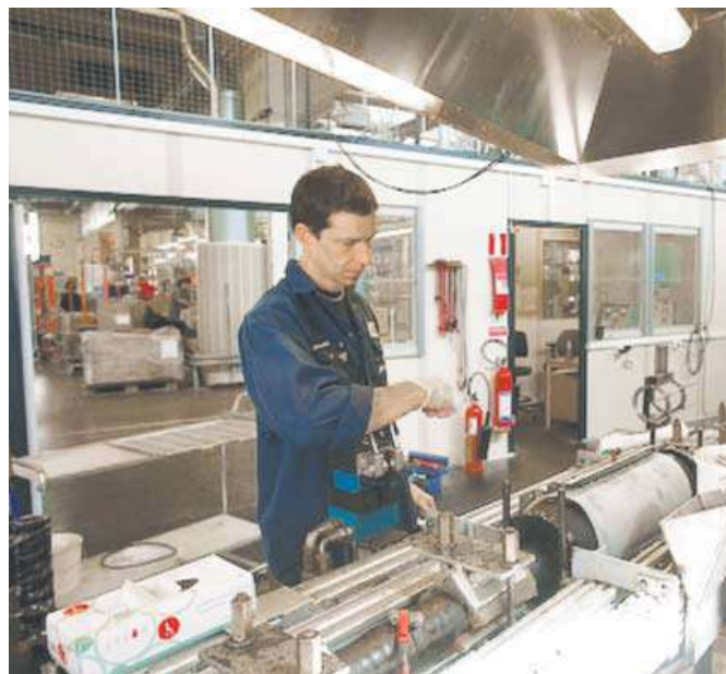
Производство концевой муфты наружной установки для кабелей с бумажной изоляцией.
