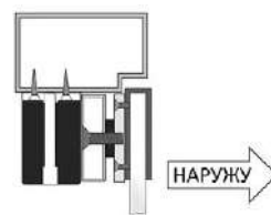
Установка с использованием U адаптера
