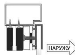
Установка с использованием U адаптера
