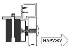
Установка с использованием L адаптера
