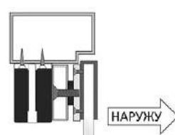
Установка с использованием U адаптера
