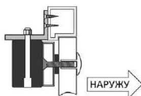
Установка с использованием L адаптера
