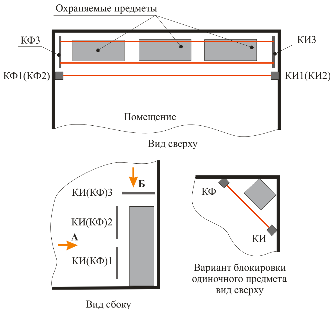
Рисунок 5.24. Схема блокировки подхода к устройствам хранения
