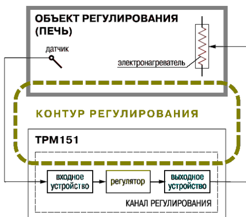
Рис. 2.15. Организация канала регулирования в приборе ТРМ151
