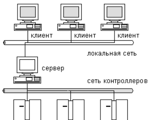
Рис. 1.11. Клиент-серверная архитектура простой системы
