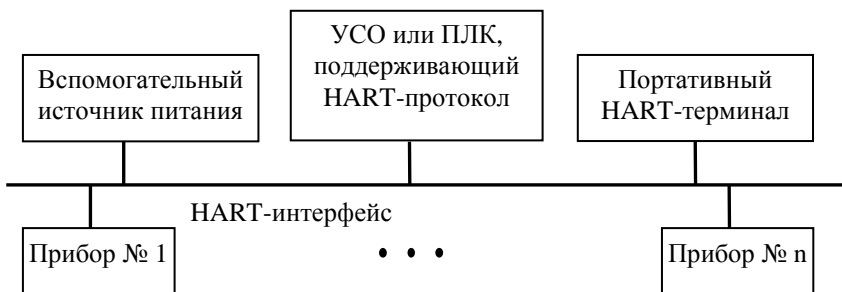
Рис. 1.5. Структурная схема подключения HART-устройств (многоточечный вариант)
