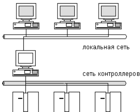
Рис. 1.10. Распределенная АСУ ТП
