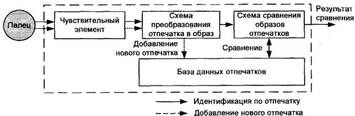
Рис. 48. Структурная схема считывателя отпечатка пальцев
