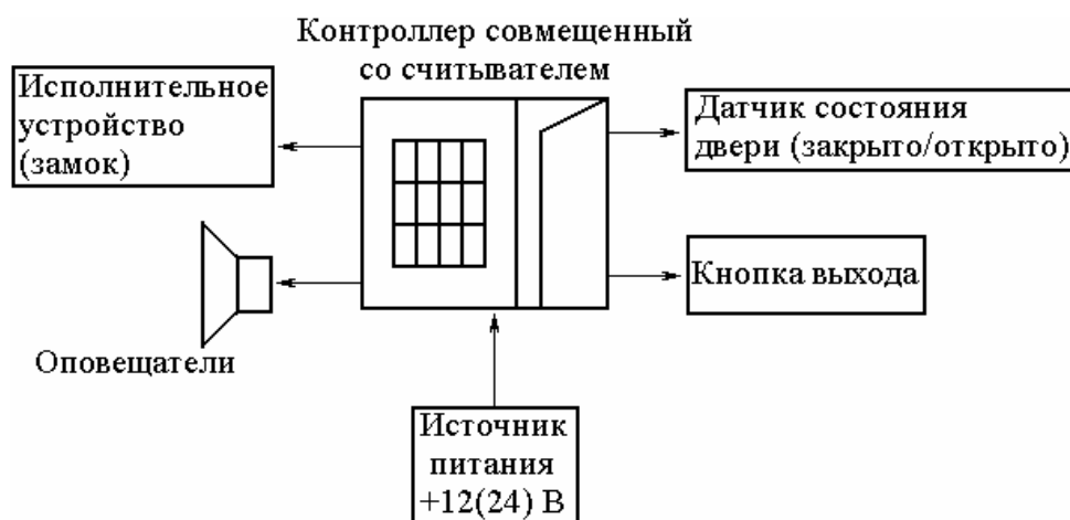
Рис. 55. Оборудование СКУД помещения с одной дверью
