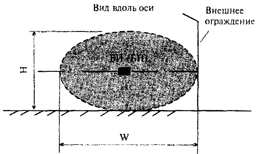
Рисунок 6.46 - Блокировка внешнего ограждения извещателем радиоволновым «Радий-1» («Радий-2»)
