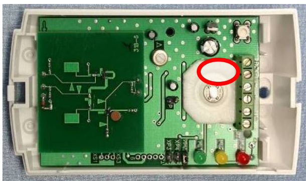
Рисунок 23 – Перемычка «Р» на плате
