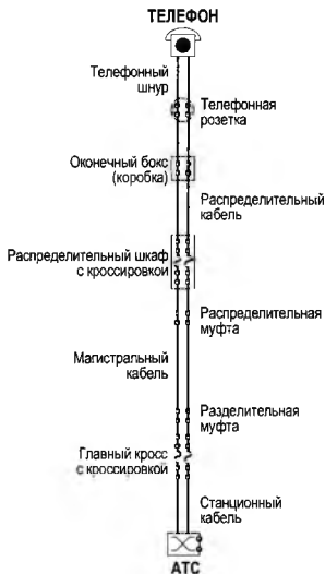
Рис. 3-2. Типовая абонентская линия содержит в тракте множество стыков
