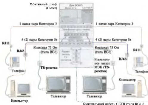
Рис. 10-В. Раздельная мультимедийная проводка для загородного дома. (При добавлении Мини-АТС и сервера образуется малый офис – SOHO)
