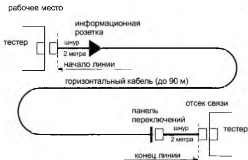
Рис. 5-9. Схема испытаний Basic Link по стандарту TSB 67
