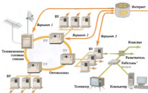
Рис. 9-А. Сегмент гибридной волоконно-коаксиальной сети, с тремя вариантами доступа в Internet. (ПУ – первичный узел, ВУ – вторичный узел)
