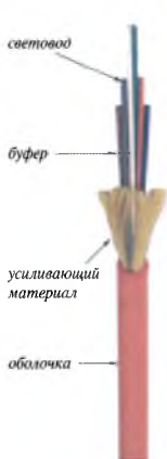
Рис. 1-С. Стандартный оптический Lap-кабель
