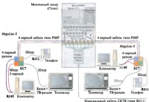
Рис. 10-С. Совмещённая мультимедийная проводка на основе продукции компании KERPEN. (Данная сеть – восьмипортовая, назначение – коттеджи; при расширении её функций – для SOHO)
