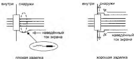
Рис. 6-9. Принцип качественной заделки кабельного экрана в экранированном разъеме
