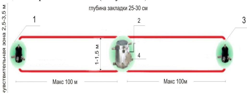
Рисунок 53 – Двухтрубная версия, где 1, 3 – компенсационные клапаны, 2 – подземный кабель к блоку управления, 4 – сенсор
