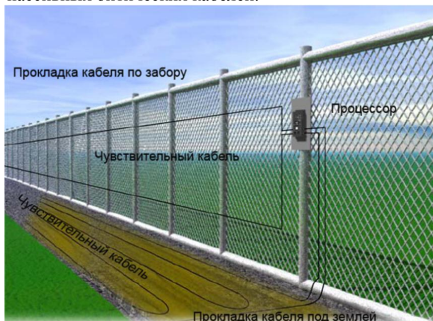
Рисунок 26 - Установка ЧЭ серии FD «Fiber SenSys»
