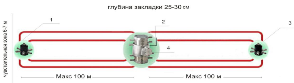
Рисунок 54 – Четырехтрубная версия, 1, 3 – компенсационные клапаны, 2 – подземный кабель к блоку управления, 4 – двойной сенсор
