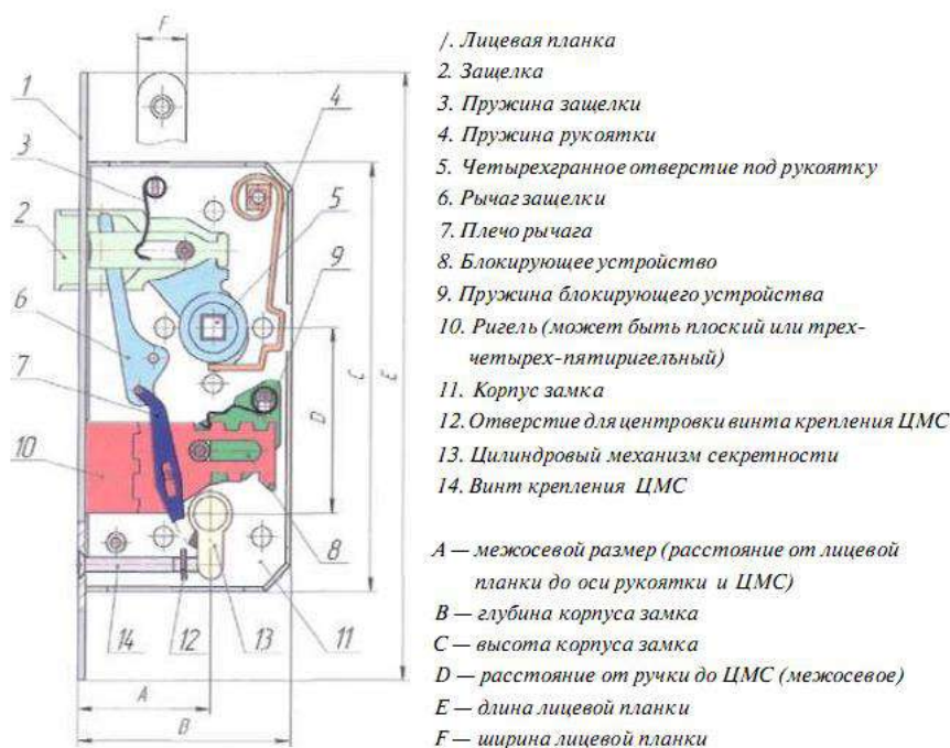
Устройство врезного замка с ЦМС (с евроцилиндром)
