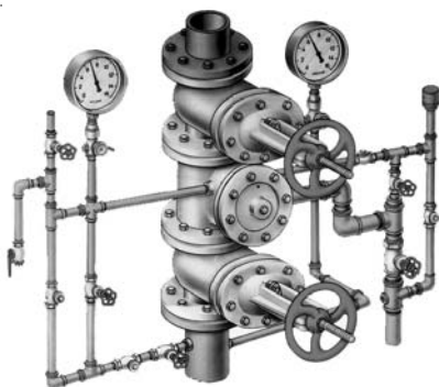
Рис. 1.7. Узел управления дренчерной установки с клапаном ГД.
