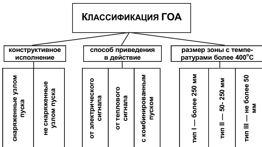
Рис. 2.6. Классификация генераторов огнетушащего аэрозоля (ГОА).
