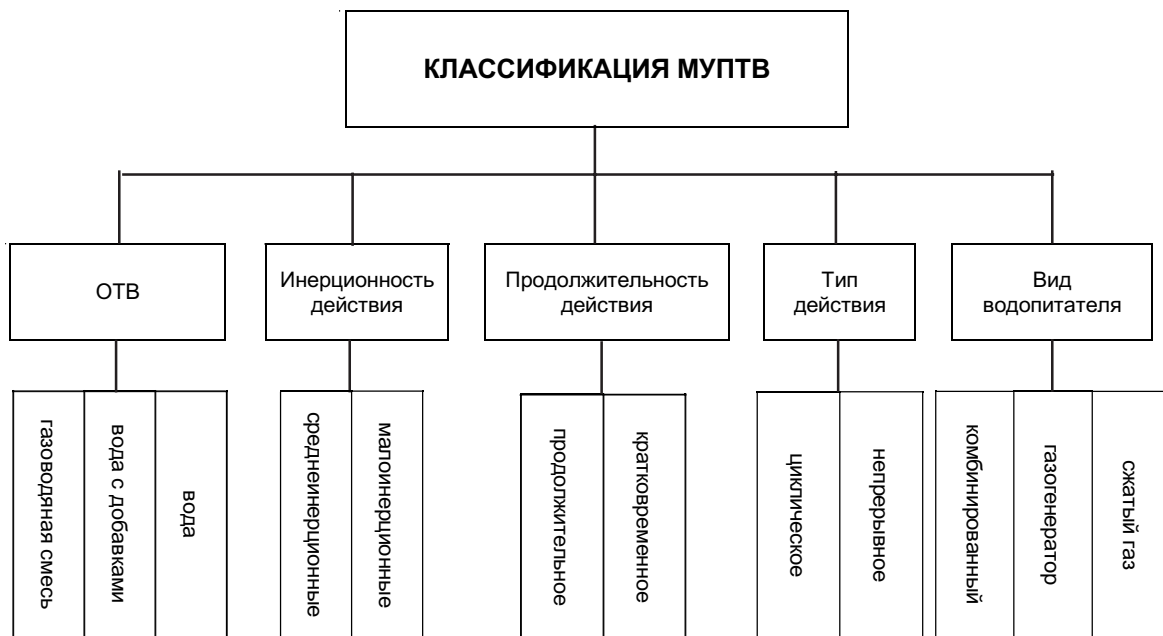
Рис. 2.3. Классификация модульных автоматических установок пожаротушения тонкораспыленной водой (МУПТВ)
