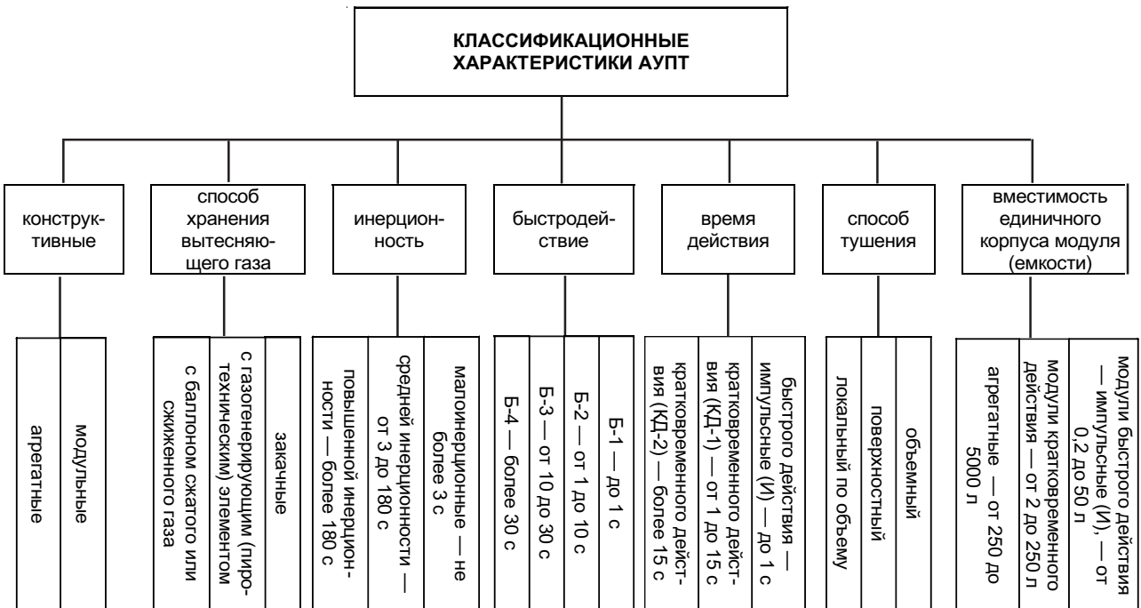
Рис. 2.4. Классификация автоматических установок порошкового пожаротушения
