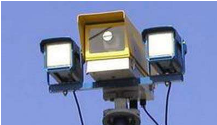
Рис.П8- Камеры мобильной системы распознавания номеров автомобилей
