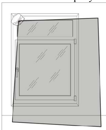
Рисунок 5.17 – Установка поверхностного извещателя внутри проема
