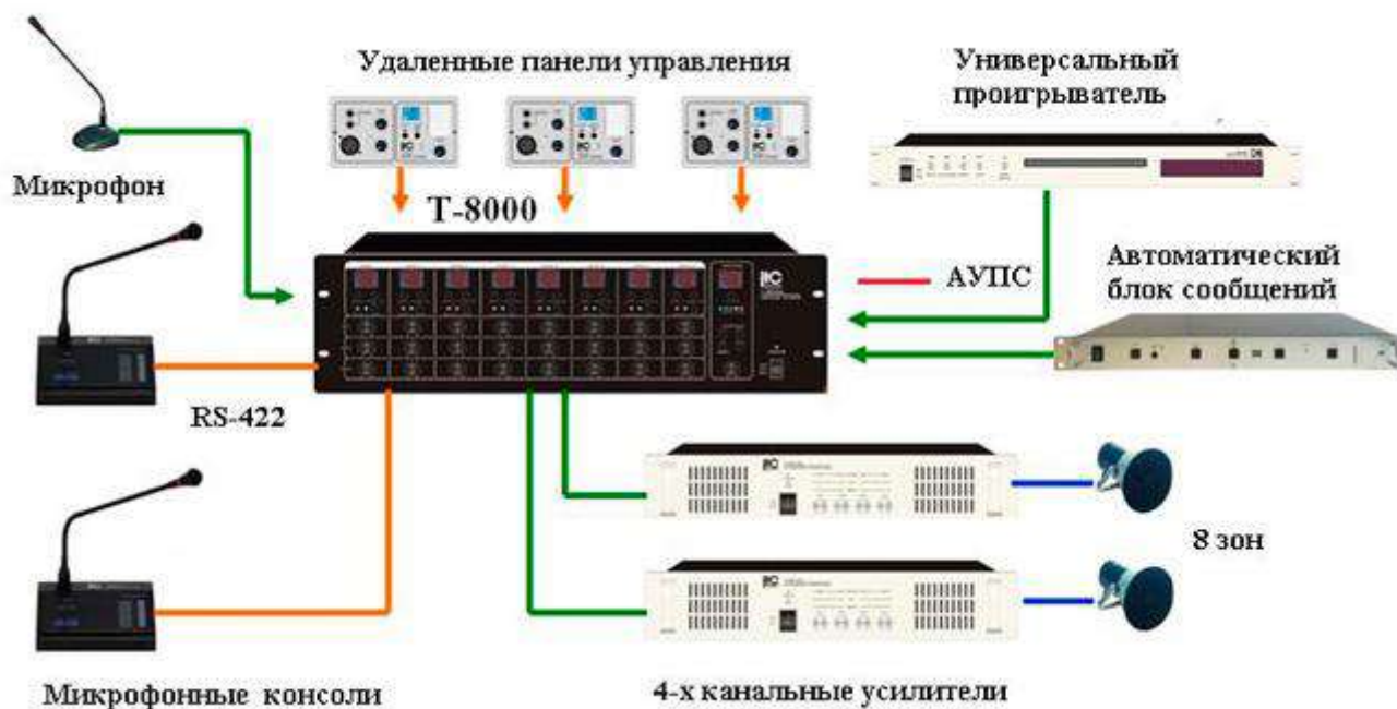
Рис.17 - Схема функционирования матричного коммутатора ITC ESCORT T-8000
