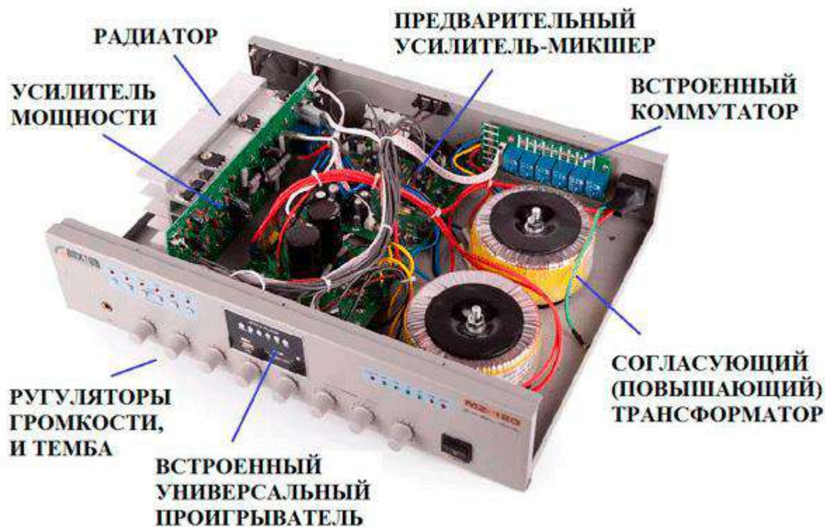
Рис.4 - Конструктивное исполнение трансляционного усилителя на примере модели ROXTON MZ-240
