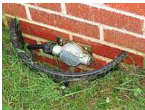
Рисунок 2.28 – Геофон под землей на кирпичной стене
