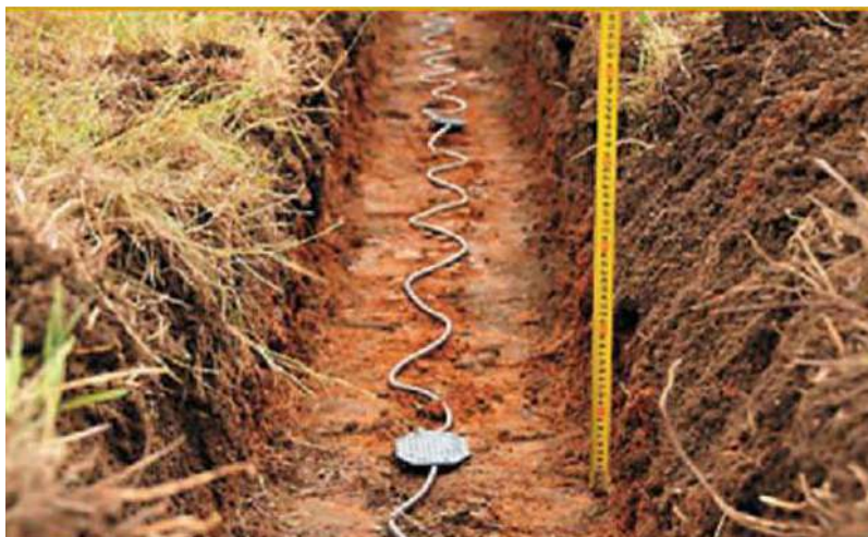
Рисунок 2.30 – Установка геофонов
