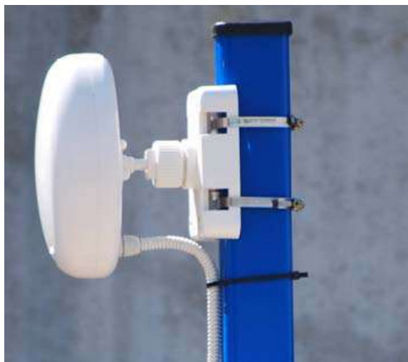
Рисунок 2.7 – Извещатель «Волна-6»
