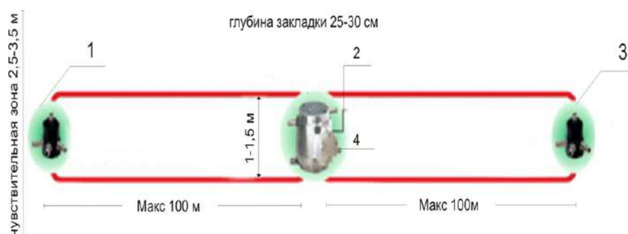
Рисунок 2.32 – Двухтрубная версия, где 1, 3 – компенсационные клапаны, 2 – подземный кабель к блоку управления, 4 – сенсор
