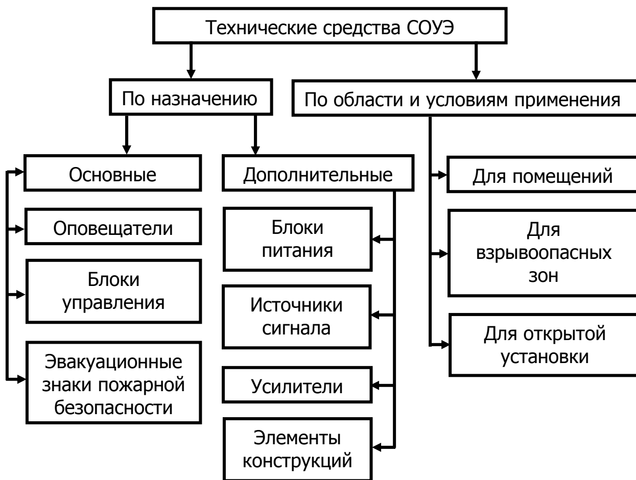
Рис. 1.3 Классификация технических средств СОУЭ
