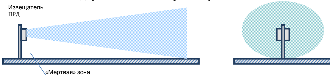
Рис. 2 Двухпозиционный радиолучевой датчик
