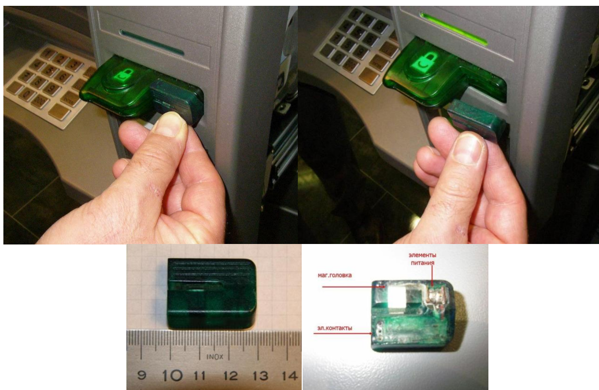
Рисунок 7.1 – Пример установки миниатюрного скиммера на антискимминговое средство пассивной защиты
