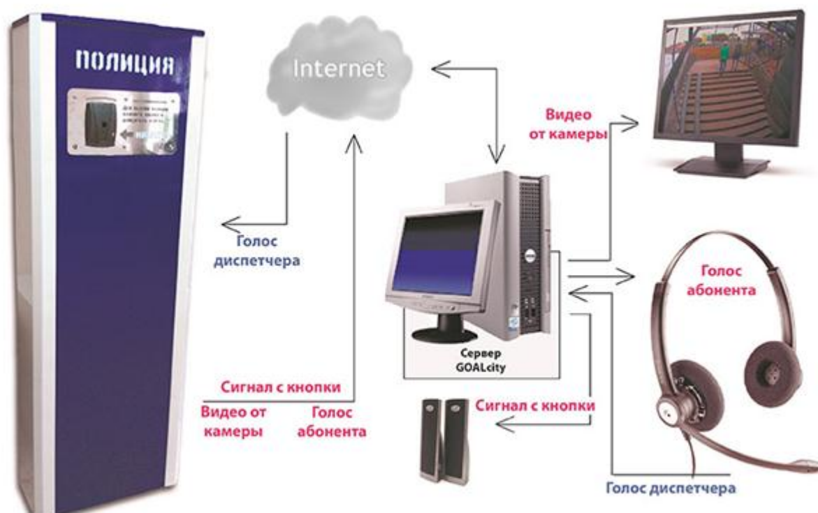
Рисунок 2.4 – Примерная схема работы системы экстренной связи с полицией
