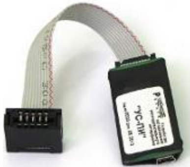
Рисунок 1.22 – УС-ПИ для конфигурирования извещателя «Шорох-3»
