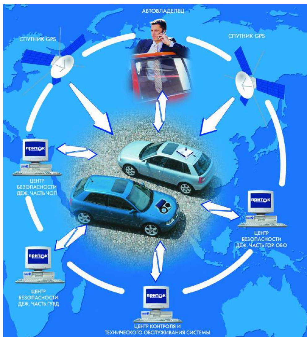
Структурная схема системы мониторинга транспортных средств «Приток-МПО»
