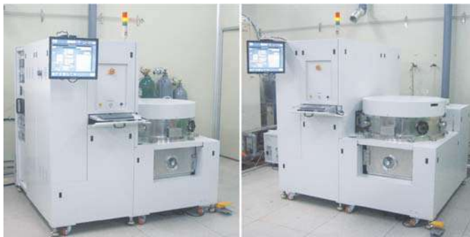
Рис. 1. Внешний вид установки CS-1000 Sputter & PVD Deposition System
