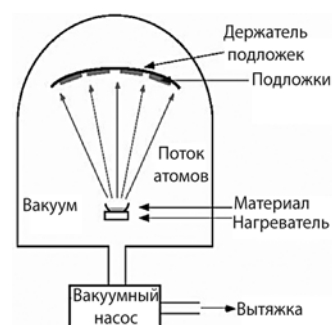
Рис. 4. Принцип термовакuumного испарения
