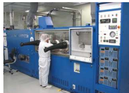
Рис. 3. Промышленная установка по росту светодиодных гетероструктур на основе GaN способом эпитаксиального осаждения из газовой фазы методом разложения металло-органических химических соединений
