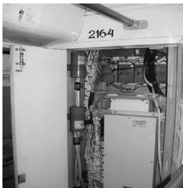
Рис. 7.10. Защита электрического шкафа трамвая генераторами огнетушащего аэрозоля.
