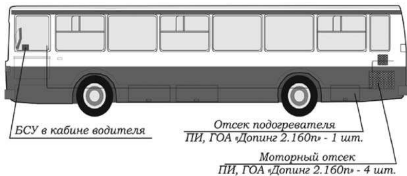
Схема размещения элементов АСОТП на автобусах модели «НЕФАЗ-5299-20-21».
