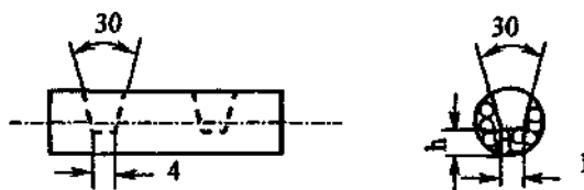
Рисунок 8.4. Вид соединения после опрессовки
