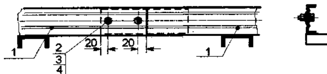
1 - мост высотой 50 мм; 2 - болт М8×16 (4 шт.), гайка М8 (4 шт.), шайба зубчатая (8 шт.)
