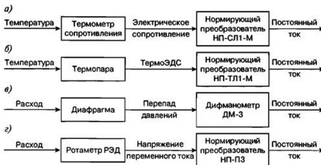
Рис. 4.9. Примеры измерительных цепей регулятора «Ремиконт»: а – с термометром сопротивления; б – с термопарой; в – с диафрагмой; г – с ротаметром
