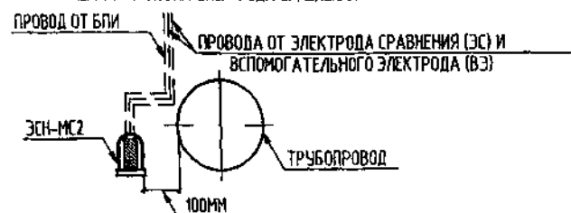
СХЕМА УСТАНОВКИ ЭЛЕКТРОДА СРАВНЕНИЯ
