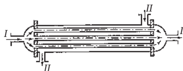
Рис. 5.1. Простейший рекуперативный теплообменник: I, II — теплоносители
