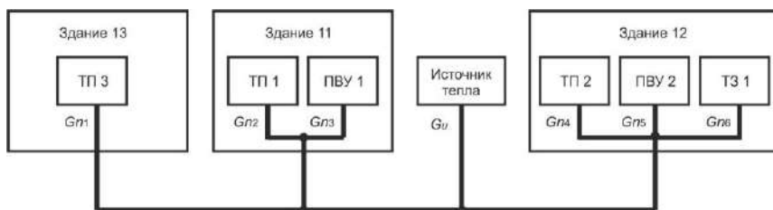
Рис. 3.23. Упрощенная блок-схема системы теплоснабжения трех зданий
