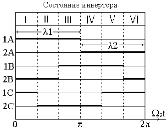
Рис. 2.19. Диаграмма состояний ключей инвертора
