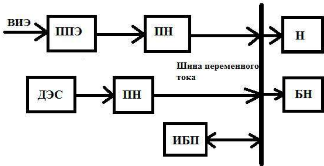
Рисунок 1.6 – Гибридный энергетический комплекс с шиной переменного тока и инверторной ДЭС
