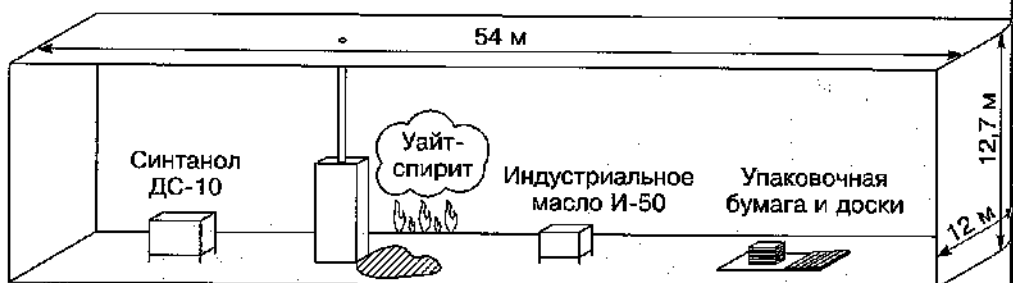
Рис. 8. Схема помещения отделения консервации и упаковки станков
