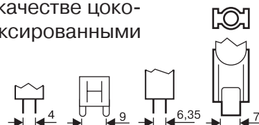
Рис. 15. Цоколи галогенных ламп накаливания
