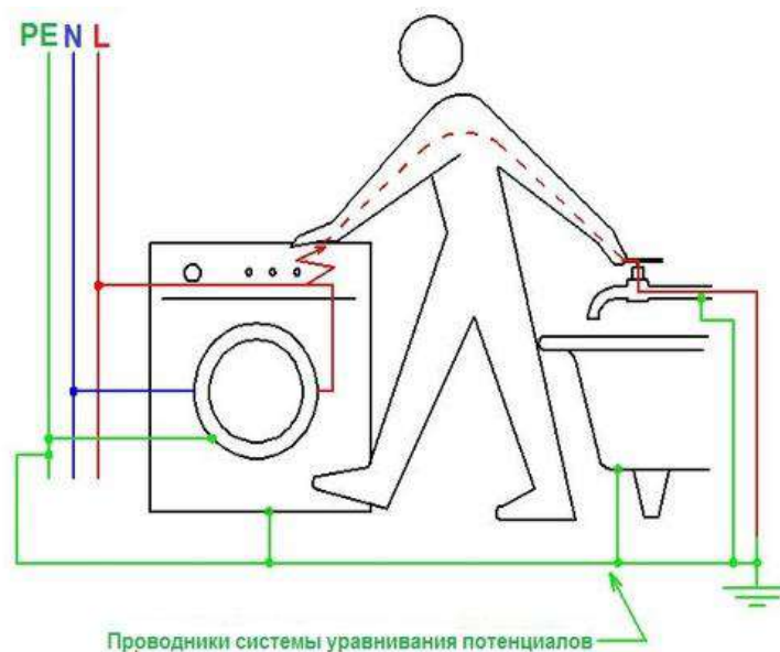
Рис. 6.6. Понятие системы уравнивания потенциалов
