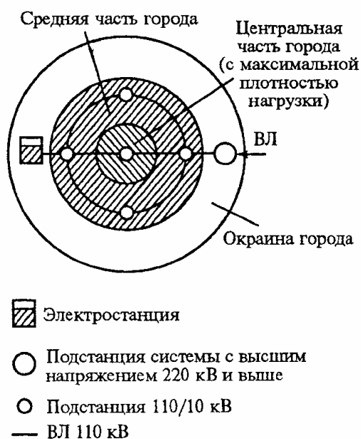
Рис. 2.7. Система электроснабжения города
