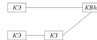
Рис. 3. Варианты реализации магистральной части СКС по стандарту TIA/EIA-568-B.1
