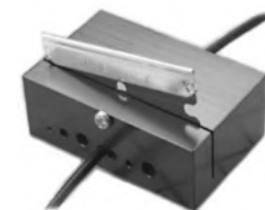
Рис. 153. Инструмент для обрезки полимерных волокон
