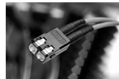
Рис. 87. Вилка разьема SC-RJ
