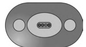
Рис. 45. Ленточный кабель внутренней прокладки
