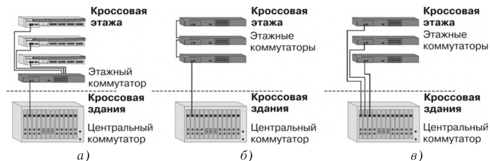
Рис. 198. Схемы соединения групповых сетевых устройств ЛВС в различных технических помещениях: а) при использовании в КЭ концентраторов и одного коммутатора уровня рабочей группы; б) в случае объединения этажных коммутаторов в стек; в) при использовании схемы прямого подключения этажных коммутаторов или концентраторов к центральному коммутатору
