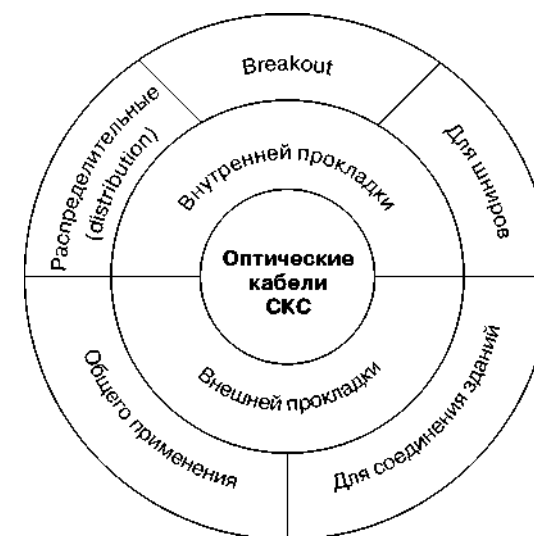
Рис. 39. Классификация оптических кабелей СКС
