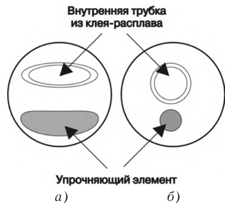
Рис. 147. Поперечное сечение элементов защиты сварного сростка термоусадочного типа: а) для ленточного волокна; б) для одиночного волокна
