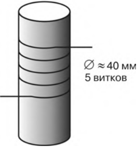
Рис. 167. Смеситель мод изгибного типа
