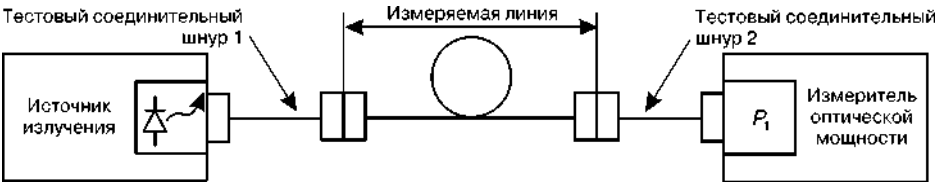
Рис. 165. Измерение величины P_L(\lambda) при реализации группы методов вносимого затухания по IEC 61280-4-1
