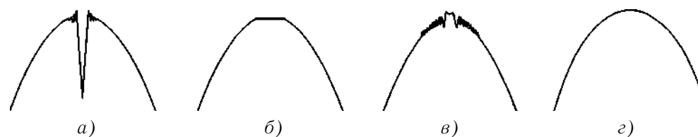
Рис. 22. Типичные профили показателя преломления градиентных многомодовых волокон:
