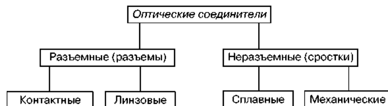
Рис. 53. Основные разновидности оптических соединителей
