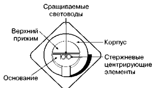
Рис. 160. Конструкция механического сплайса Unicam
