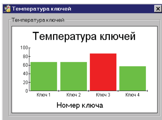
Рис. 7.1. Формы системы контроля: а) основные параметры СБЭП; б) настройка выключения СБЭП; в) температура ключей инвертора; г) форма истории
