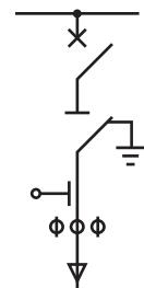
Внешний вид модуля показан на рис. 1. Этот модуль является базовым модулем КРУ серии ТЕЛ. Основное назначение модуля – коммутация отходящей линии или ввода. Номинальный ток главной цепи модуля №1 - 400А, модуля №1а - 630А.
