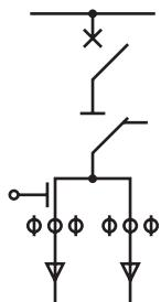
Модуль №2 (см. рис. 2) отличается по составу от модуля №1 наличием двухкабельного токоприемника 1 (с возможностью подключения двух силовых кабелей сечением до 240 мм<sup>2</sup>) и разъединителя вместо разъединителя-заземлителя<sup>1</sup>. Благодаря наличию двухкабельного присоединения номинальный ток главной цепи модуля составляет 630 А. Его основное назначение – коммутация ввода. Модуль может также устанавливаться на отходящих линиях, имеющих транзитное питание.
