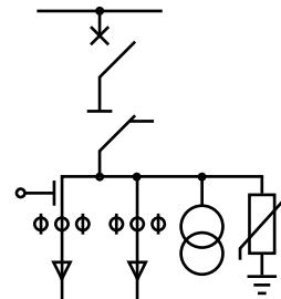
Внешний вид модуля показан на рис. 3. Основное назначение этого модуля – коммутация ввода. Трансформаторы напряжения, постоянно подключенные по высокой стороне к кабельной линии, позволяют получить информацию о наличии напряжения на кабеле и организовать АВР с самовозвратом.
