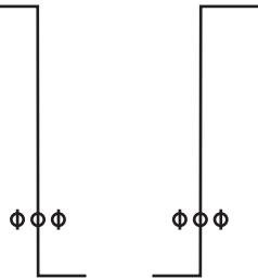
Присоединение без коммутационных аппаратов с элементами секционирования (левого или правого расположения)
