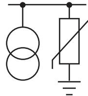
Этот модуль содержит трансформаторы напряжения и ограничители перенапряжений. Ограничители перенапряжений, защищающие сборные шины, устанавливаются так же, как в модуле №8. Установка трансформаторов напряжения показана на рис. 8.
