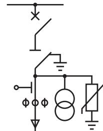
Аналог модуля №5, рассчитанный на однокабельное присоединение. Вид модуля показан на рис. 10.
