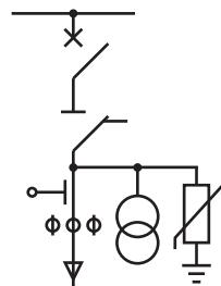
Аналог модуля №3, рассчитанный на однокабельное присоединение. Вид модуля показан на рис. 11.
