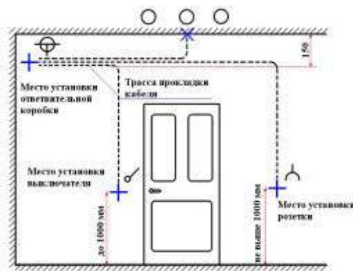
Рис.П.3. 8 Высота установки розеток и выключателей в административно-конторских, лабораторных и других помещениях.
