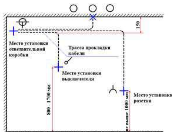
Рис.П.3. 8 Высота установки розеток и выключателей в административно-конторских, лабораторных и других помещениях.
