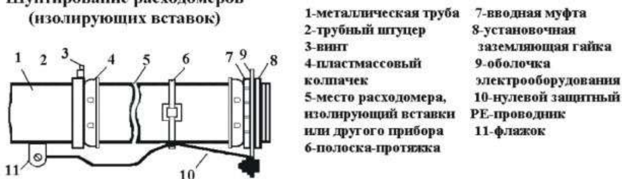
Рисунок 7.9 - Шунтирование расходомеров, задвижек.
