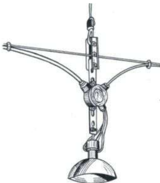
Рисунок 4.11.5 Узел ответвления к светильнику
