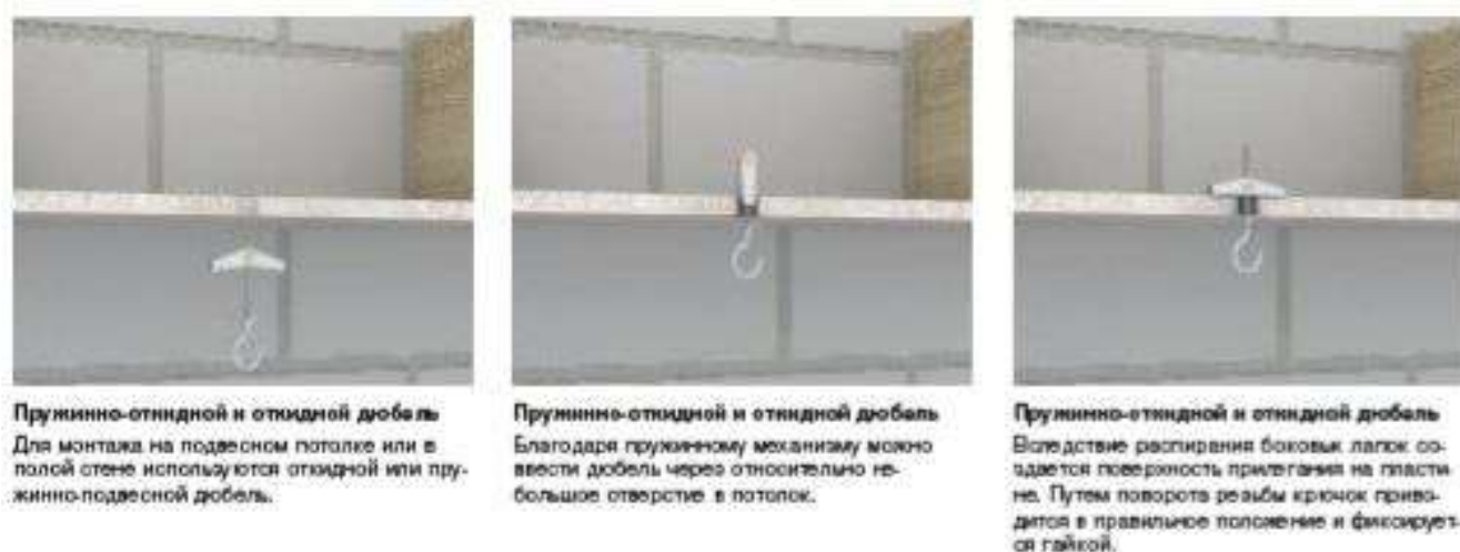
Рисунок 6.4 – Использование пружинно-откидного и откидного дюбель для монтажа на подвесном потолке
