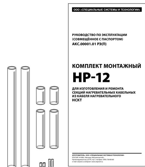
Комплект НР-12 предназначен для изготовления секций нагревательных кабельных из нагревательного кабеля марки НСКТ и установочного провода, а также для соединения и ремонта отрезков нагревательного кабеля НСКТ непосредственно на объекте.
